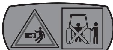
Traktör ve makinenin arasında kalan bölgede ezilme tehlikesi vardır. Makineye güvenli mesafede durunuz.
