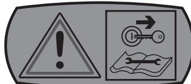
Makineyi bakıma almadan önce makineyi durdurunuz ve kullanma kılavuzuna başvurunuz.
