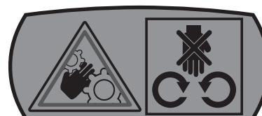
Ezilme ve sıkışma tehlikesi vardır. Hareketli parçalardan uzak durunuz.
